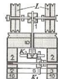
402/2 Rez cez mlecí stroj a uhlový prevod. Na mieste nábojov č. 4 pre K1 a K2 môžu byť použité aj náboje č. 6.
